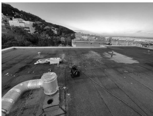
Tests par fumigène : Résultat négatif
