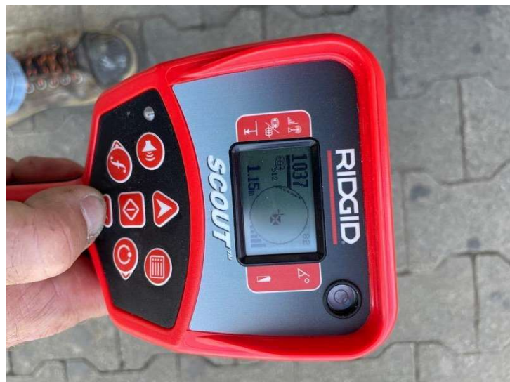
Géolocalisation à 120cm de profondeur
